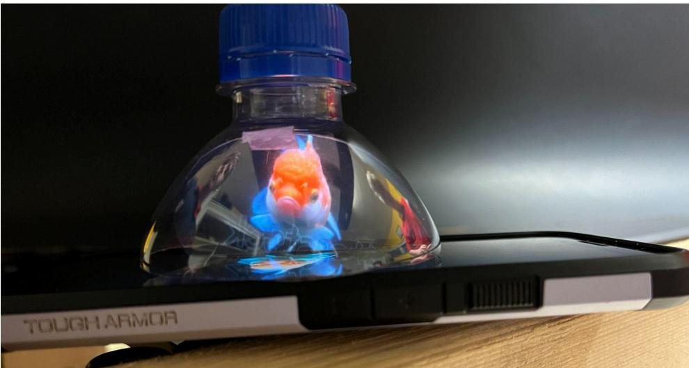
Par la suite nous avons fait un test avec un dôme créé à partir d'une bouteille de plastique avec un écran découpé dans une boîte transparente de muffins. Ceci nous a permis de confirmer notre choix d'y aller pour l'effet avec un dôme.
